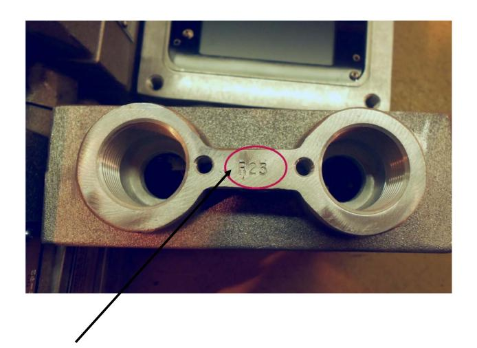
IF LOT CODE R23 IS STAMPED ON THE ELECTRICAL ENCLOSURE ON YOUR MACHINE, THE ENCLOSURE MUST BE REPLACED.
